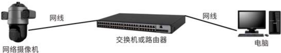
图1-2 通过交换机或路由器连接示意图
